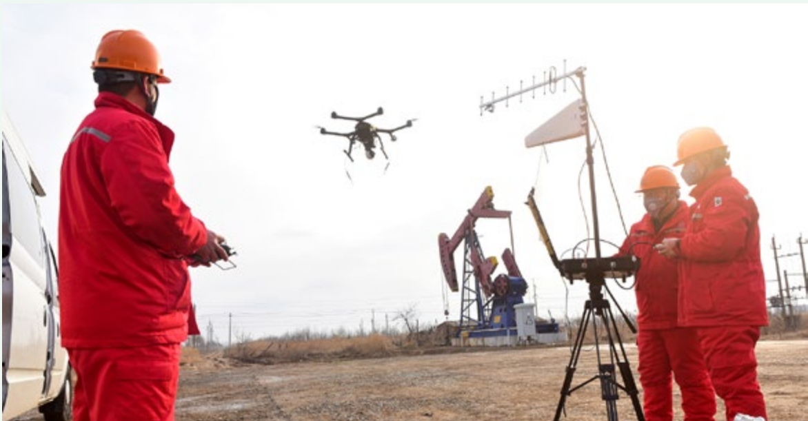
胜利油田采用无人机对重点油区、油井、输油干线进行巡检
